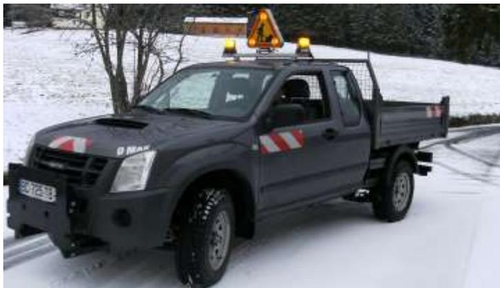
Le choix s'est porté sur ce modèle pour des critères de charge utile, de puissance et de prix. Les amortisseurs et les lames de ressort ont été renforcés. Une benne basculante et une lame de déneigement ont été conçues et montées par l'entreprise HIVIACO de Cornimont.
